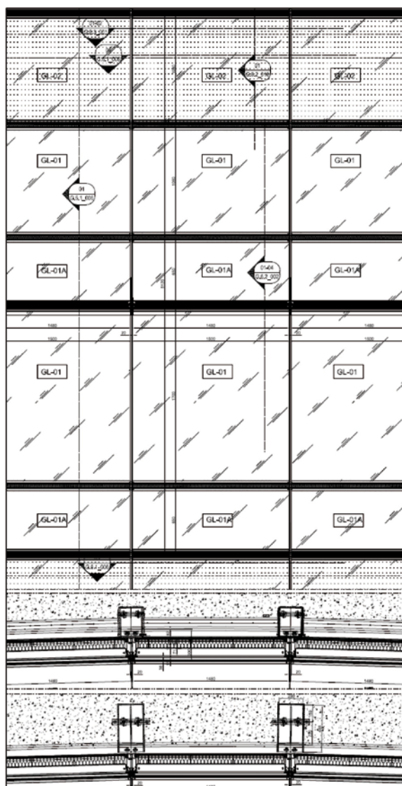
Modularità tipica del curtain wall sia in verticale che in orizzontale (fonte Permasteelisa).
